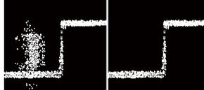
合成激光 ON/OFF 两个状态下拍摄的图像。从而消除环境光的干扰。
